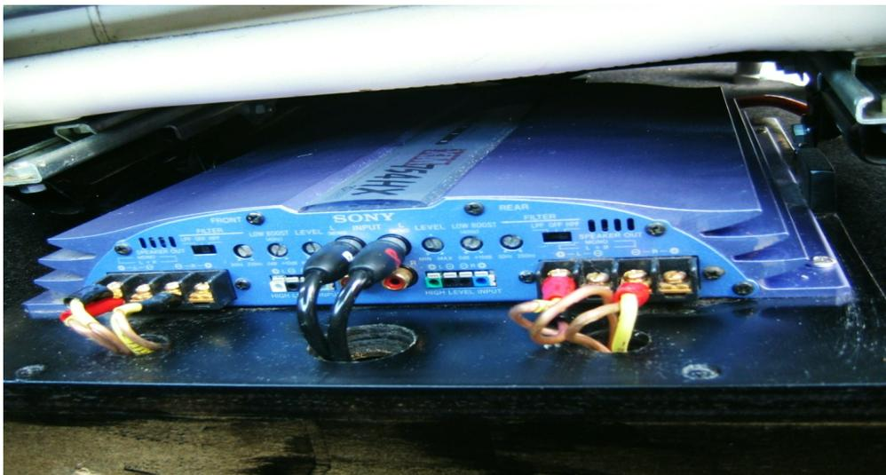
*Sony Vierkanalendstufe unter dem Beifahrersitz versteckt und befestigt.*
